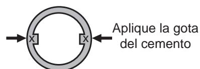
1. Para posición cerrada solamente (evite que la válvula sea cerrada en la posición abierta): cemente el anillo de cerradura en el torre del vástago del cuerpo con las aletas alineadas con la línea de la válvula y de la tubería.
